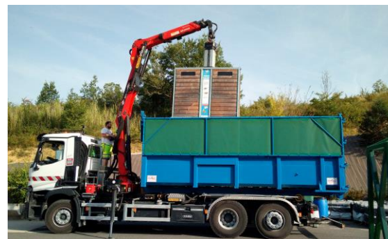
III.3.8. Collecte en camion-grue
